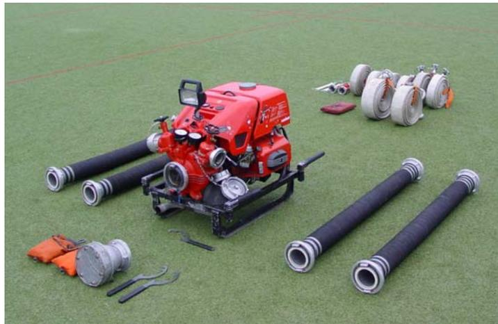
*Bild 2 Tragkraftspritze mit Saugschläuchen*
