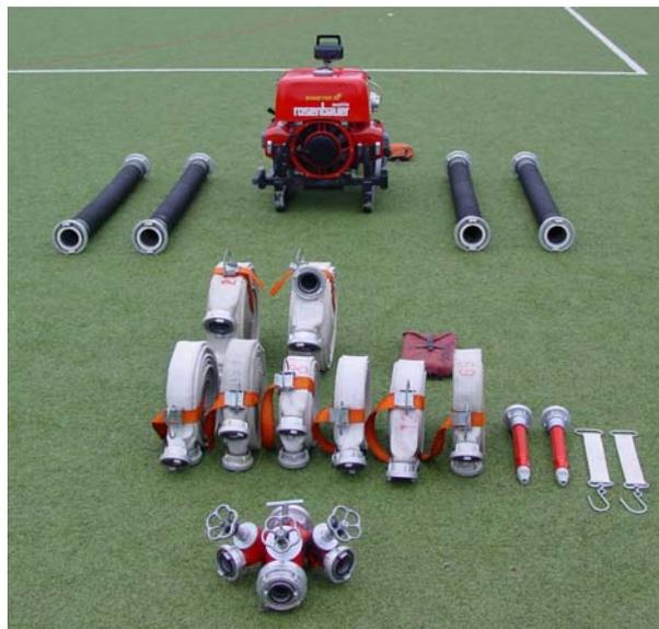
*Bild 3a: Druckschläuche und Verteiler*
